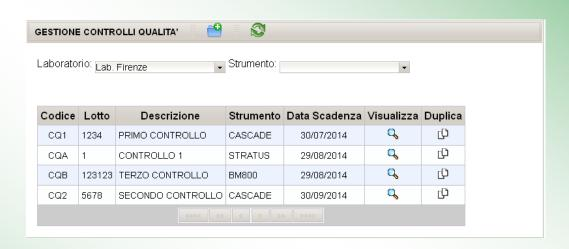
Visualizzazione e configurazione dei controlli di qualità. La tabella dei controlli può essere filtrata per laboratorio e/o strumento. E' possibile modificare un controllo esistente, inserirne uno nuovo o duplicare un controllo esistente, per risparmiare tempo nell'inserimento dati.
